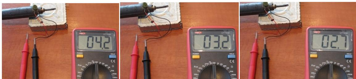
В нашем случае подопытный термистор работает вполне исправно, его сопротивление уменьшается одновременно с нагревом паяльника.
