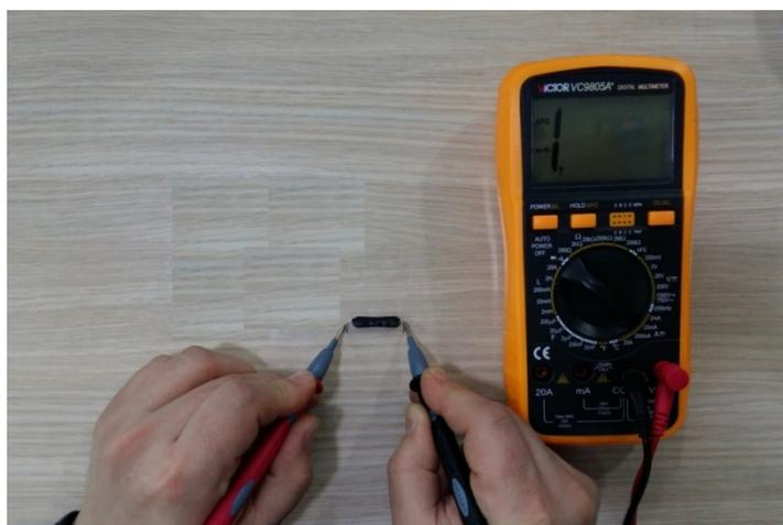
В результате мультиметр выдает нам сопротивление 0 Ом, и звуковой сигнал. Это означает что предохранитель целый. Противном случае, мультиметр показывает бесконечное сопротивление и никакого звукового сигнала.
